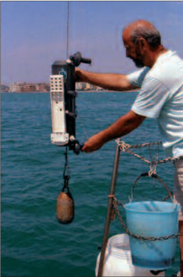
Fig. 6 - Campionamento lungo la colonna d'acqua mediante bottiglia Niskin.
