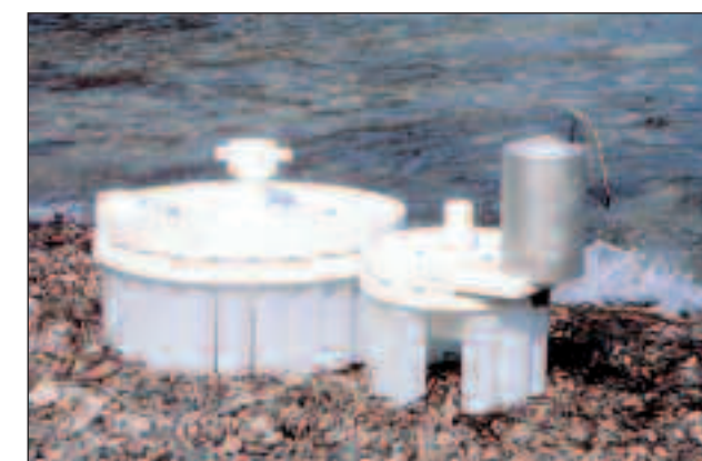
Fig. 3 - Motore per l'avanzamento e elettronica per la programmazione (contenitore in metallo) e carousel con bottiglie di campionamento per trappola per sedimenti. Sono mostrati carousel con 12 e 24 bottiglie.
