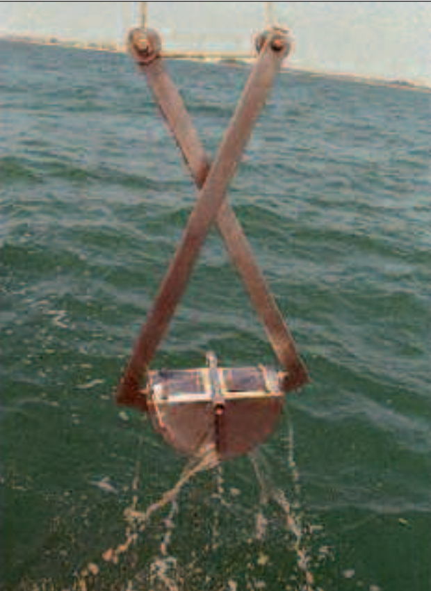
Fig. 2 - Benna per il campionamento del bentos e dei sedimenti.
