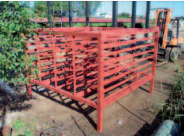
Fig. 12 - Struttura a galleggiamento controllato.
